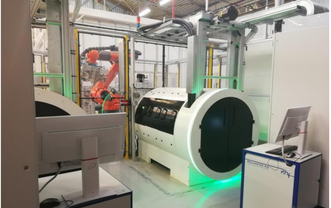
Chaque moteur électrique est testé sur ce banc d'essai. Des tests plus poussés, dont un test destructif, sont également réalisés sur des moteurs pris au hasard chaque jour.
