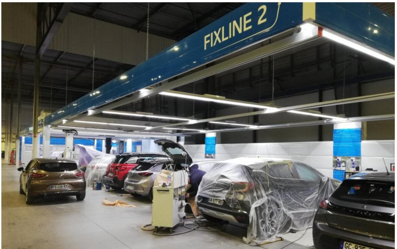
100 personnes travaillent à la carrosserie-peinture en utilisant notamment le système d'agencement FixLine pour déplacer les véhicules sur des rails.
